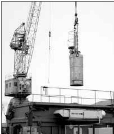
Перегрузочный контейнер опускают на реактор для приема топливной сборки
