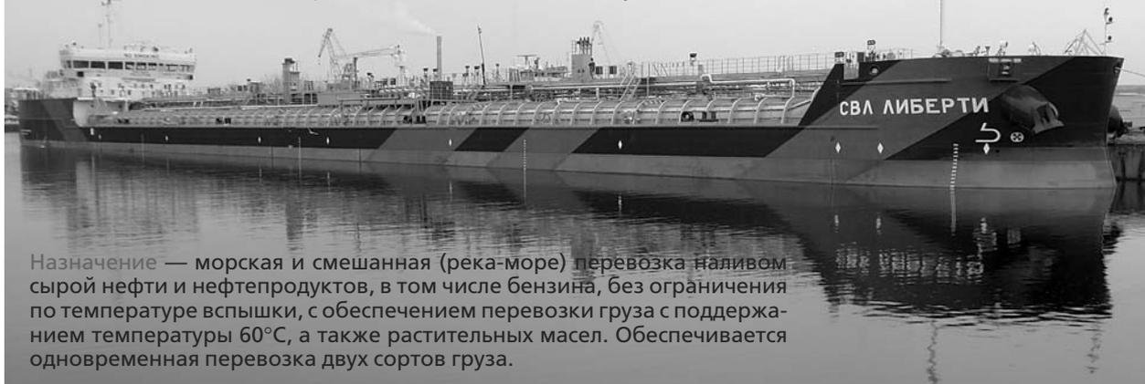
Назначение — морская и смешанная (река-море) перевозка наливом сырой нефти и нефтепродуктов, в том числе бензина, без ограничения по температуре вспышки, с обеспечением перевозки груза с поддержанием температуры 60°C, а также растительных масел. Обеспечивается одновременная перевозка двух сортов груза.
